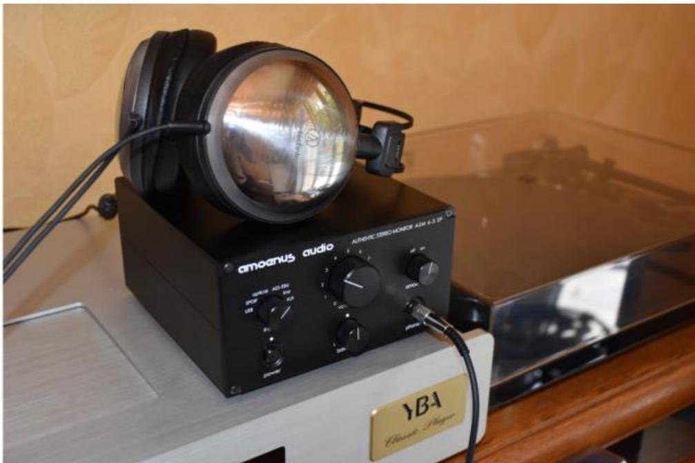
Sous un format compact, la face avant reçoit une sortie casque au seul format jack 6,35, un réglage de volume sonore manuel, un sélecteur spécifique destiné à vous plonger au milieu des enceintes et d'avoir un champ stéréo étiré sur 180 degrés. Les sources sonores peuvent apparaître comme alignées entre vos oreilles. Lorsque l'ASM 6.3 SP est utilisé comme préamplificateur associé à un bloc de puissance et des enceintes acoustiques, ce dispositif peut alors être mis hors fonction.
