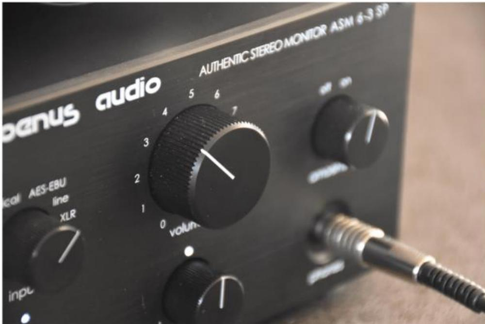
Si le concepteur a installé un potentiomètre de volume d'origine Alps, il précise que sur le plan purement audio, il n'a aucune fonction en tant que tel, car le volume de l'audio est contrôlé électroniquement (PGA2320) après le convertisseur D/A. Celui-ci de préciser que les deux entrées analogiques offrent une conversion analogique-numérique.
